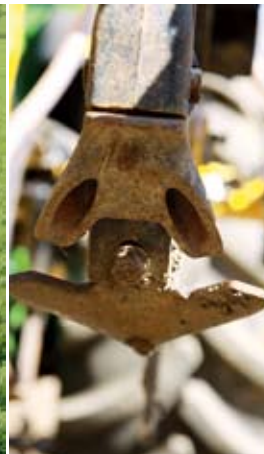
Saatgutablage Nach einem schmalen Meißelschar, das eine tiefe Furche zieht, folgt ein Gänsefußschar und legt neben der Furche die Saat ab.
