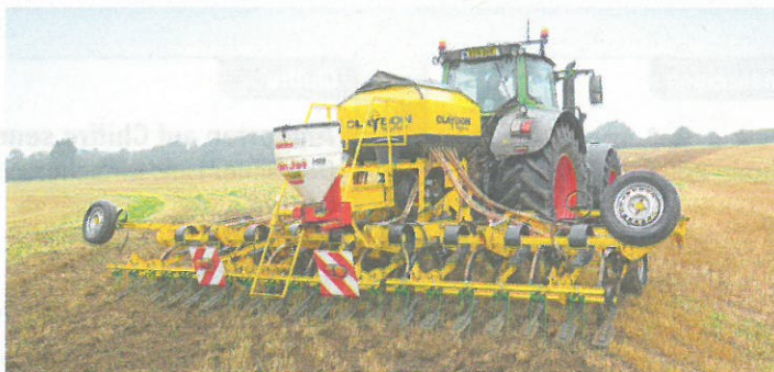
Problemloses Arbeiten auch im englischen Regen: Eine Claydon Hybrid als Anbaugerät und Schneckenkornstreuer bei der Aussaat von Zwischenfrüchten auf Gerstestoppeln.
