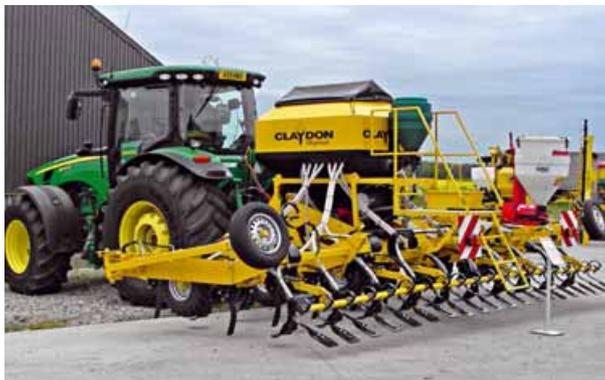
Il sistema brevettato da Claydon si basa sull'impiego di una doppia ancora che consente una lavorazione a strisce larghe fino a 18 cm
