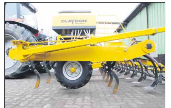
Den forreste smalle tand skal løsne jorden og lave mulighed for afløb, så nedbør infiltrerer hurtigt i den dybe rille.
