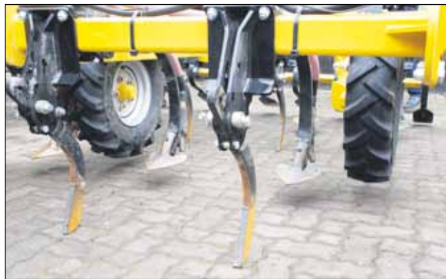
Den forreste stive justerbare smalle tand minder om en grubbertand og løsner jorden i 10-18 centimeter dybde.
