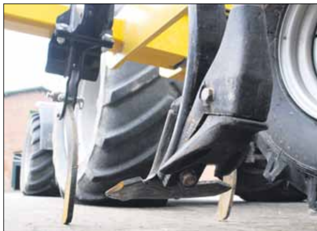
Det bagerste tandskær løfter jorden op samtidig med at frøene placeres i løsnet jord. Hvede etableres i bånd på 17,5 cm og så er der 12,5 cm mellem båndene med planter.
