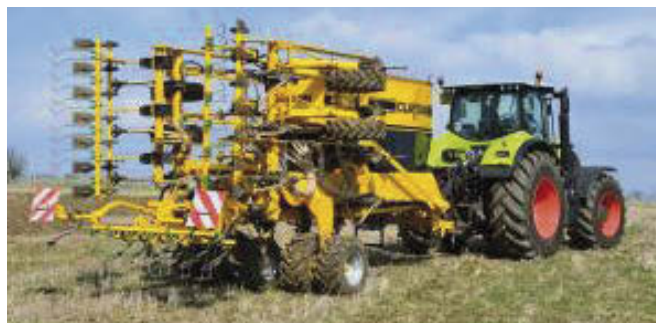
■ La versione da 6 m si ripiega a 3 m per il trasporto, quella da 8 m a 2,95 m.
