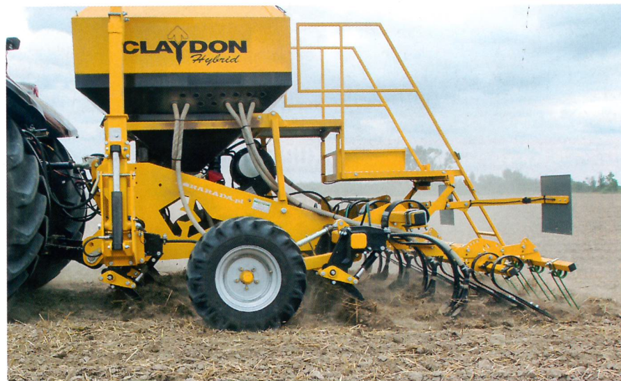
Claydon Hybrid to maszyna do uprawy pasowej, w której nie zastosowano wału doprawiającego po zębach spulchniających. W tym miejscu zamontowano włókę łopatkową.
