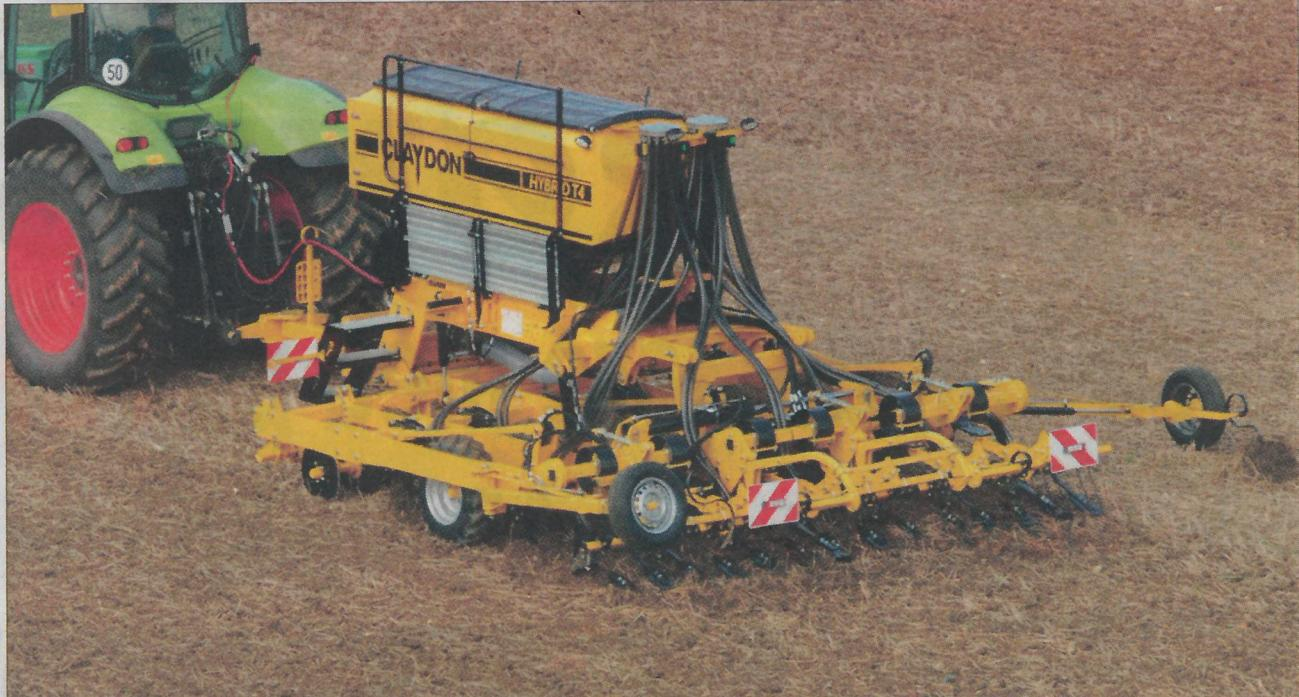
Den bugserede Claydon Hybrid T leveres i arbejdsbredder på fire, seks og otte meter og med tanke til såsæd og gødning der er delt 40/60 og har en kapacitet på 3.500 - 5.500 liter. Foto: Claydon.
