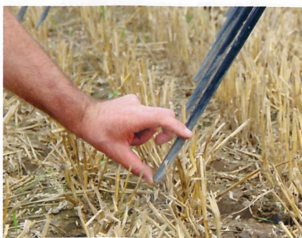
Sprężyste palce biorą udział w płytkim spulchnianiu gleby. Pracują czynnie (mają kontakt z glebą) jedynie na długości ok. 5-10 cm.
