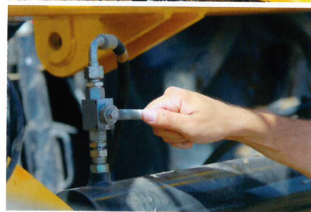
Składanie i rozkładanie narzędzia odbywa się jednym siłownikiem hydraulicznym, umieszczonym w poprzek ramy głównej. Na czas transportu zamykamy zawór, aby agregat się przypadkowo nie rozłożył.
