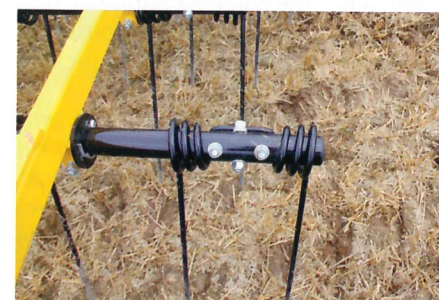
Pary sprężystych zębów są mocowane na rurach wsporczych, a przykręcane blisko nich śruby znajdują się tam na zasadzie odbojnika i utrzymywania właściwej pozycji i nie pozwalają na poprzeczne przesuwanie się zębów.
