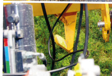
Podczas składania i rozkładania narzędzia należy zwrócić uwagę na ułożenie przewodów hydrauliki. Zdarza się, że zahaczają o dolny zaczep ciągnika lub znajdują się pomiędzy ramą główną i składaną brony, co grozi ich uszkodzeniem.
