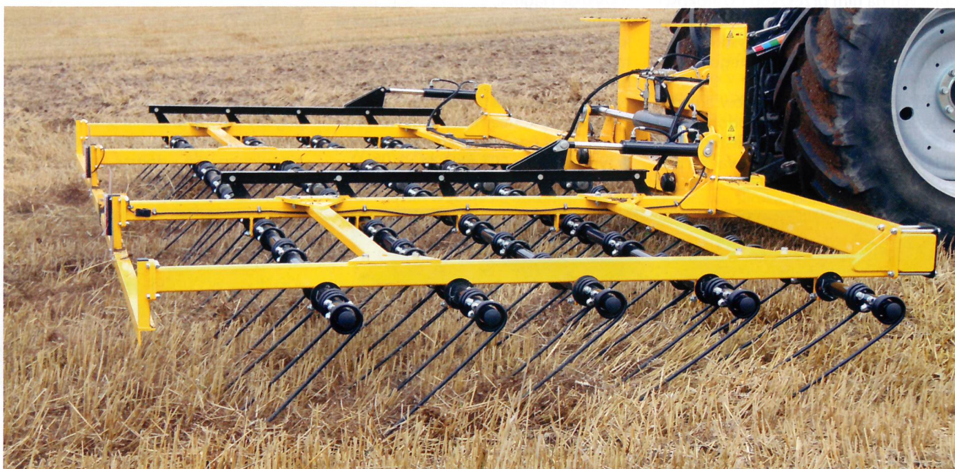
Jak podaje producent – brona palcowa Claydon służy do usunięcia chwastów i pozbycia się ślimaków przed przystąpieniem do siewu. Ponadto równomiernie rozproszcza słomę i wpływa na szybkie kiełkowanie nasion chwastów i samosiewów.
