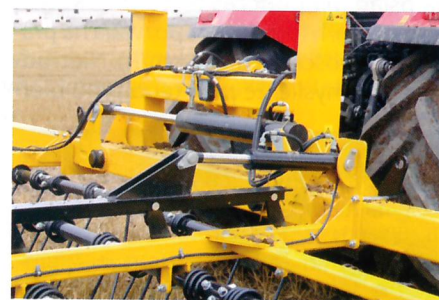
Pary sprężystych zębów są mocowane na rurach wsporczych, a przykręcane blisko nich śruby znajdują się tam na zasadzie odbojnika i utrzymywania właściwej pozycji i nie pozwalają na poprzeczne przesuwanie się zębów.
