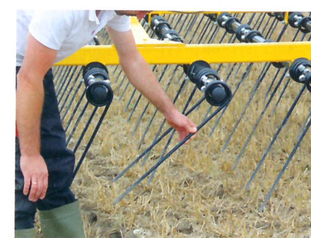
Zęby są bardzo elastyczne, bardzo mocno się odginają od pierwotnej pozycji. Pozwala to na bezstresową pracę nawet w bardzo trudnych warunkach.
