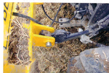
Producent przewidział pracę brony z różnymi ciągnikami o różnej wysokości. Świadczą o tym podwójne dolne mocowania oraz aż cztery otwory dla sworzni mocującego górnego wspornik TUZ-u.
