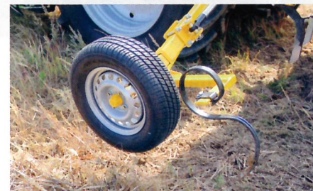
Podwójny boczny znacznik siewnika Claydon przyciąga kołem wysokie rośliny lub ściernisko, a zamontowany za nim ząb dodatkowo rysuje w glebie ślad.
