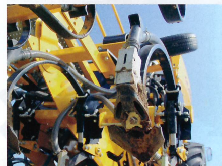
Ta redlica siewna rozdziela nasiona na dwie części – jest zamontowana w linii zęba uprawowego.
