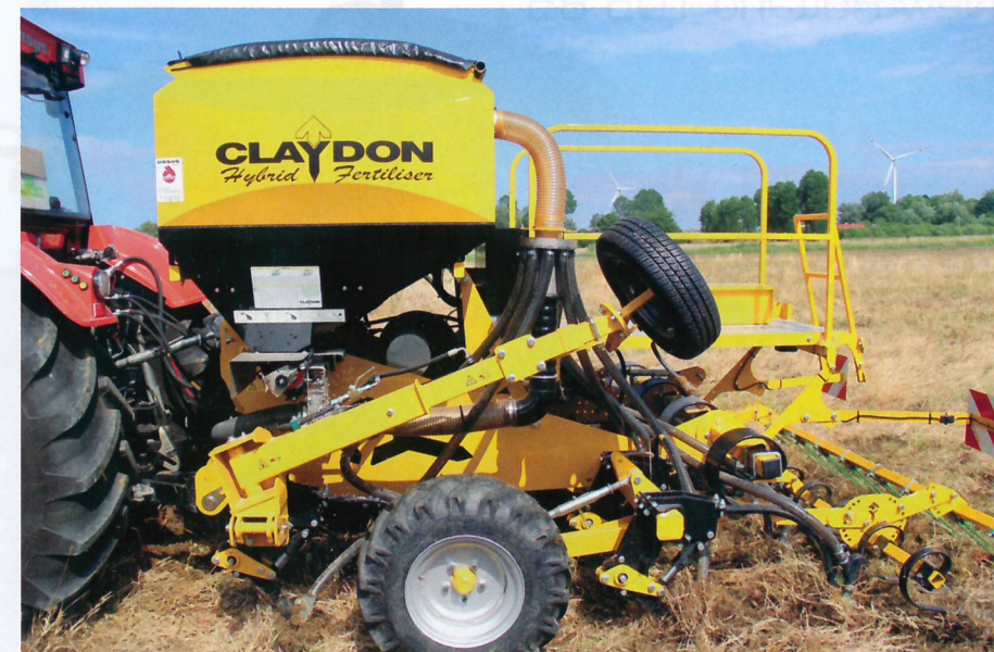
Jedną z zalet maszyny do uprawy pasowej marki Claydon jest wyjątkowo duża odporność na zapychanie się resztami pożywnymi.
