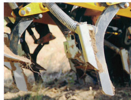
Przedni ząb siewnika Claydon może pracować na głębokości do 30 cm i standardowo ma zamontowany dozownik nawozu.
