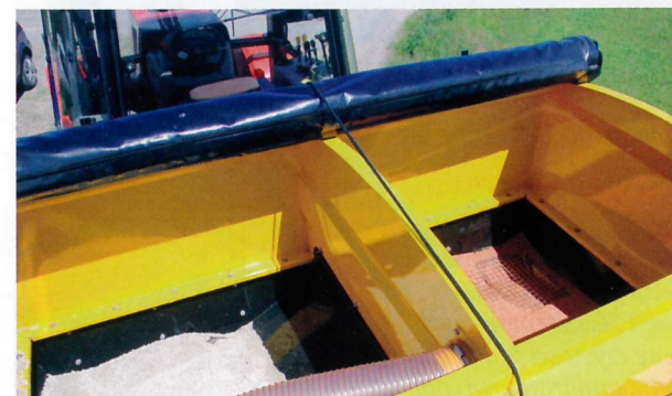
Zbiornik siewnika Claydon podzielony jest na dwie komory – nasienną i nawozową.
