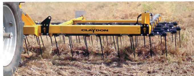
Brony Claydon to proste narzędzia, których praca polega na wznoszeniu gleby przez solidne sprężynowe palce ułożone w pięciu rzędach.
