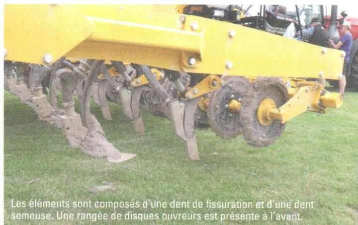
Les éléments sont composés d'une dent de fissuration et d'une dent semeuse. Une rangée de disques ouvreurs est présente à l'avant.
