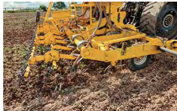
Пружинна борона забезпечує рівномірний розподіл соломи
