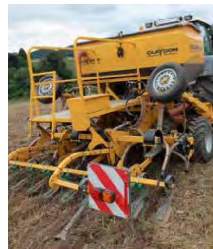
Денна продуктивність сівалки 3 м Evolution коливається від 20 га. Для її приводу потрібен трактор потужністю мінімум 150 к.с.
