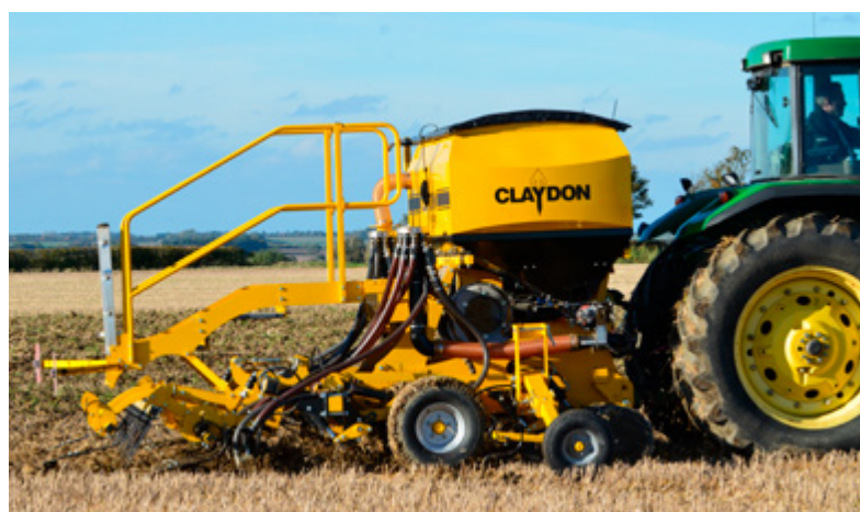
Сівалка з передньою розпувальною лапою
