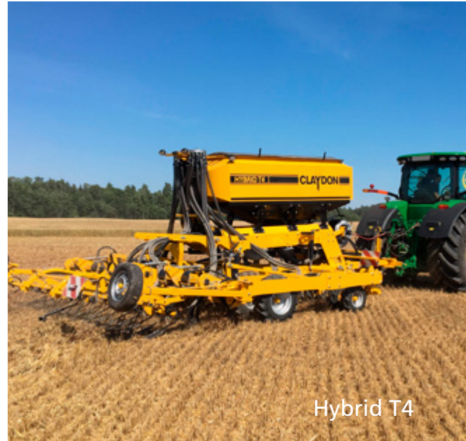
Налаштування Hybrid T3 здійснюється шляхом додавання причіпного пристрою до навісної 3-метрової сівалки Hybrid
