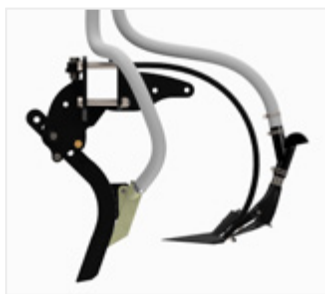
Внесення добрив передньою лапою (закладання добрив під насіння)
