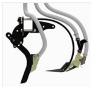
Унесення добрив (закладання над і під насінням)
