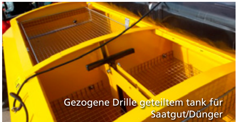
Anbau-Drillmaschine mit geteiltem Tank für Saatgut/ Dünger
