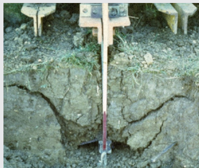
Abbildung 3. Die Bodenstörung, die mit einer Zinke unterhalb ihrer kritischen Tiefe (links) und mit einem Untergrundlockerer mit Scharauslegern (rechts) erzeugt wird
