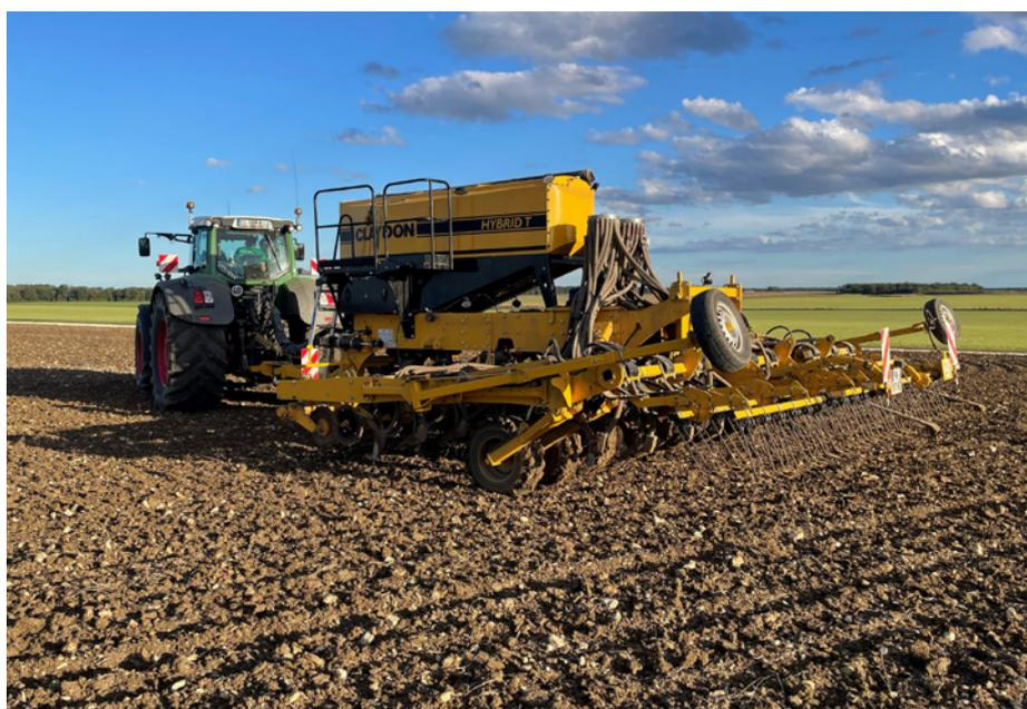
**Double trémie avec 5500 litres de capacité**
