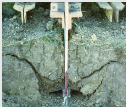
Figure 3. Perturbation des sols produite par une dent travaillant sous sa profondeur critique (à gauche) et par une charrue sous-soleuse à ailes (à droite)
