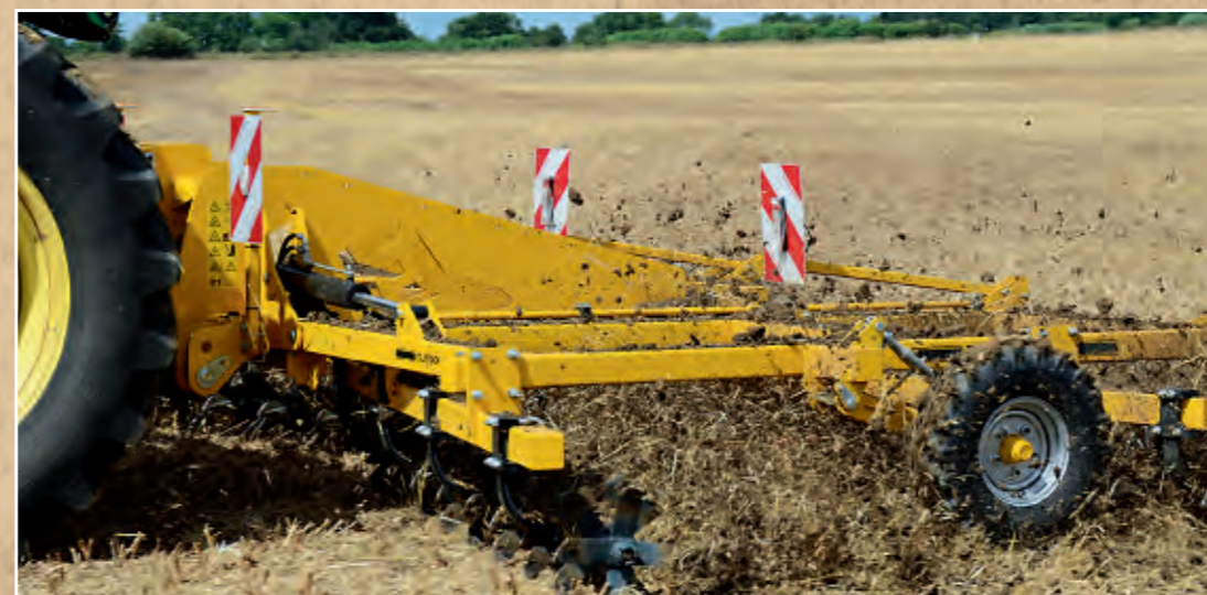
Ротаційна борона TerraStar® із легкістю вирішить проблеми великої кількості рослинних решток, загорання органічних добрив без порушення ґрунтового профілю
