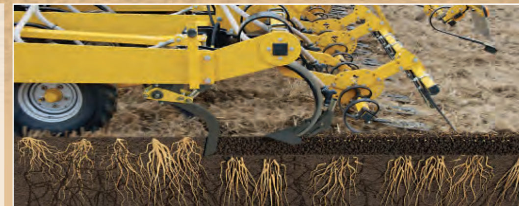
Унікальна передня лапа для рихлення (патент Claydon) дає змогу виконувати зональний обробіток, усуває локальне ущільнення, аерує ґрунт, утворює тріщини в ґрунті для легкого проростання коріння та дренажний канал, закладає добрива в зону росту коренів
