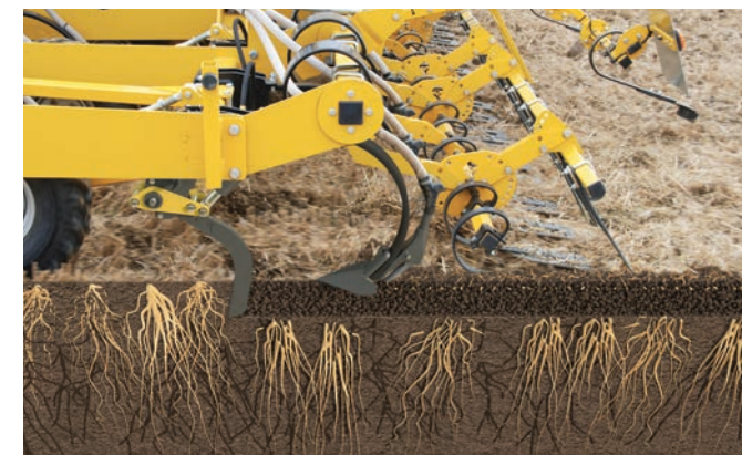
Добрива можна вносити за допомогою передніх лап на глибину, поверх насіння або використовуючи обидва варіанти
