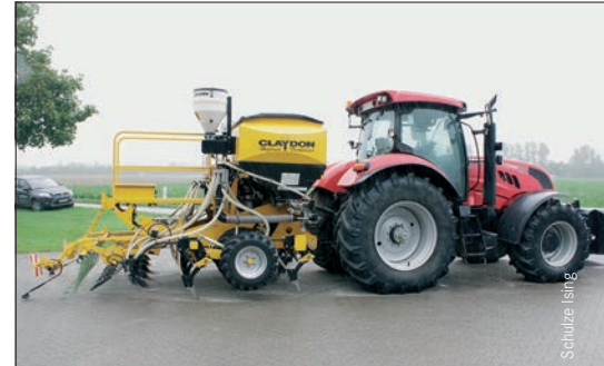
Auf der Claydon Drillmaschine ist ein Dosiergerät für die Ausbringung von Mäuseködern montiert.
